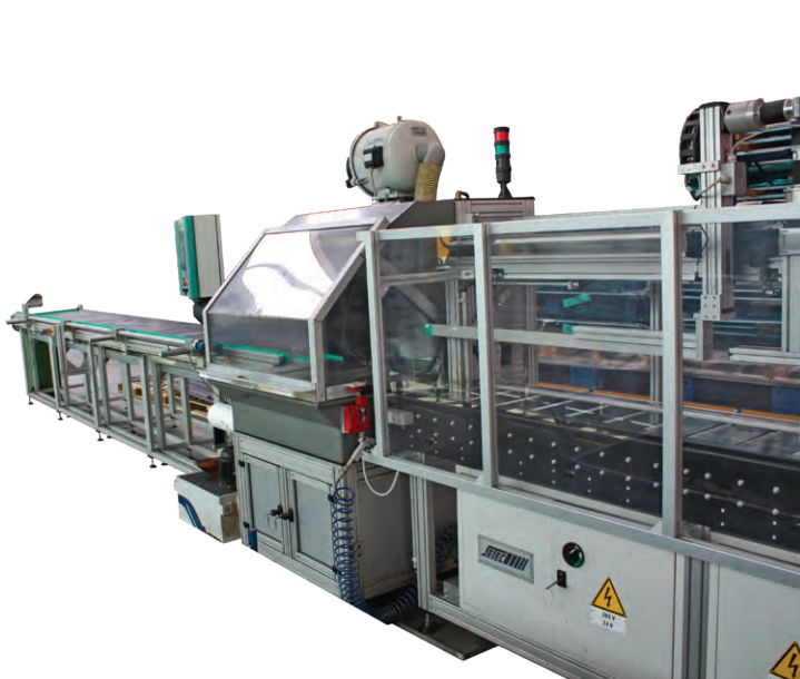
Linea automatica taglio di precisione viti/cromati / Chrome tubes/screws precision cutting automated machine
