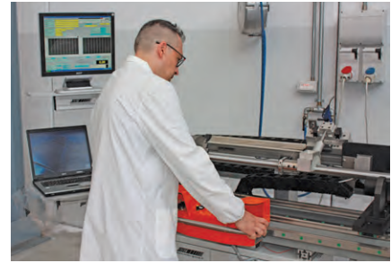
Controllo precarico assieme vite - madrevite / Ball screw preload torque measurement bench
